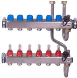
Das Set besteht aus einem Vor- und Rücklaufbalken. Jeder Verteilerbalken wird zusätzlich mit zwei 1/2" Innengewinden für Entlüftungsventile und Füll- und Entleerhähne geliefert. Der Verteiler ist in schalldämmten Haltern vormontiert. Der Inhalt ist mit Bezeichnungsaufklebern und Einstellanleitung montiert.
