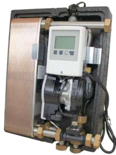
**Anwendung:** Die Frischwasserstation eco 25 eignet sich ideal für die zentrale Erwärmung von Trinkwasser in Heizsystemen. Das Heizwasser wird aus dem Pufferspeicher entnommen und durch den Plattenwärmetauscher geführt, um das Trinkwarmwasser direkt bei Bedarf zu erhitzen. Ein Pufferspeicher ist erforderlich, um den notwendigen Heizwasservolumenstrom zu gewährleisten.
