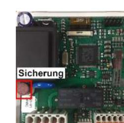
Hat der Regler trotz eingeschalteter Netzspannung keine Funktion und Anzeige, ist evtl. die interne Gerätesicherung defekt. Dann das Gerät wie unter C beschrieben öffnen, alte Sicherung entfernen und überprüfen.
