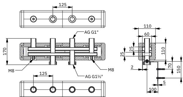
Dieser Heizungsverteiler besteht aus einer stabilen Stahlkonstruktion mit thermisch getrennten Vor- und Rücklaufkammern. Er ist speziell für kleinere Heizungsanlagen konzipiert und bietet einen Durchsatz von 3,3 m<sup>3</sup>/h, ideal für Anlagen mit einer Leistung von bis zu 75 kW. Die Verteiler sind werkseitig grundiert und unter Druck geprüft, um höchste Qualität und Sicherheit zu gewährleisten. Eine vorinstallierte Isolierung sorgt für Energieeffizienz und optimalen Schutz.
