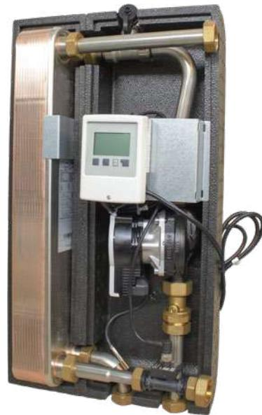
**Anwendung:** Die Frischwasserstation eco 40 eignet sich ideal für die zentrale Erwärmung von Trinkwasser in Heizsystemen. Das Heizwasser wird aus dem Pufferspeicher entnommen und durch den Plattenwärmetauscher geführt, um das Trinkwarmwasser direkt bei Bedarf zu erhitzen. Ein Pufferspeicher ist erforderlich, um den notwendigen Heizwasservolumenstrom zu gewährleisten.
