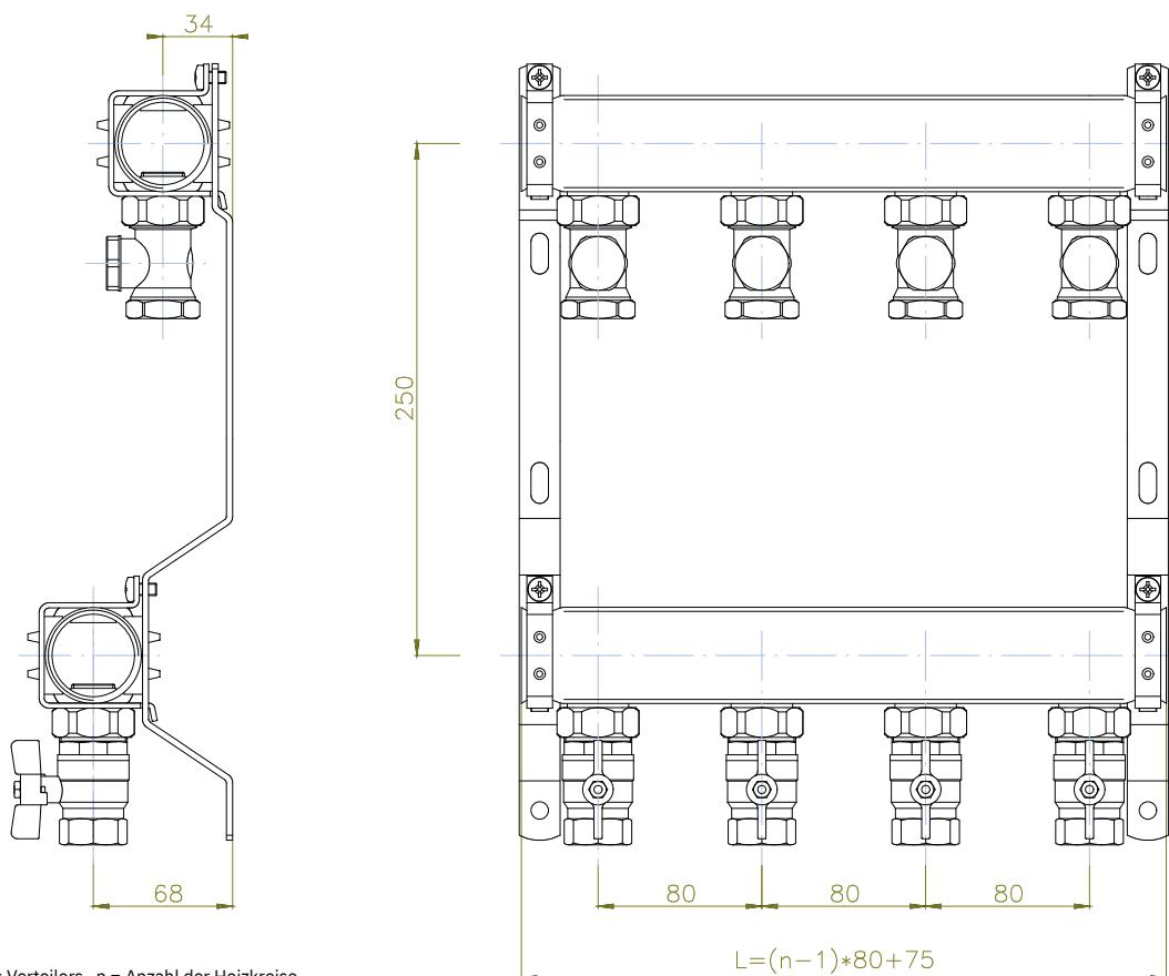
L = Länge des Verteilers n = Anzahl der Heizkreise
