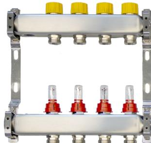
**Lieferumfang:** Set besteht aus Vor- und Rücklaufbalken, jeweils mit zwei G½" Innengewinden für Entlüftungsventile. Vormontiert in schallgedämmten Haltern, inklusive Bezeichnungsaufklebern und Einstellanleitung in Karton verpackt.
